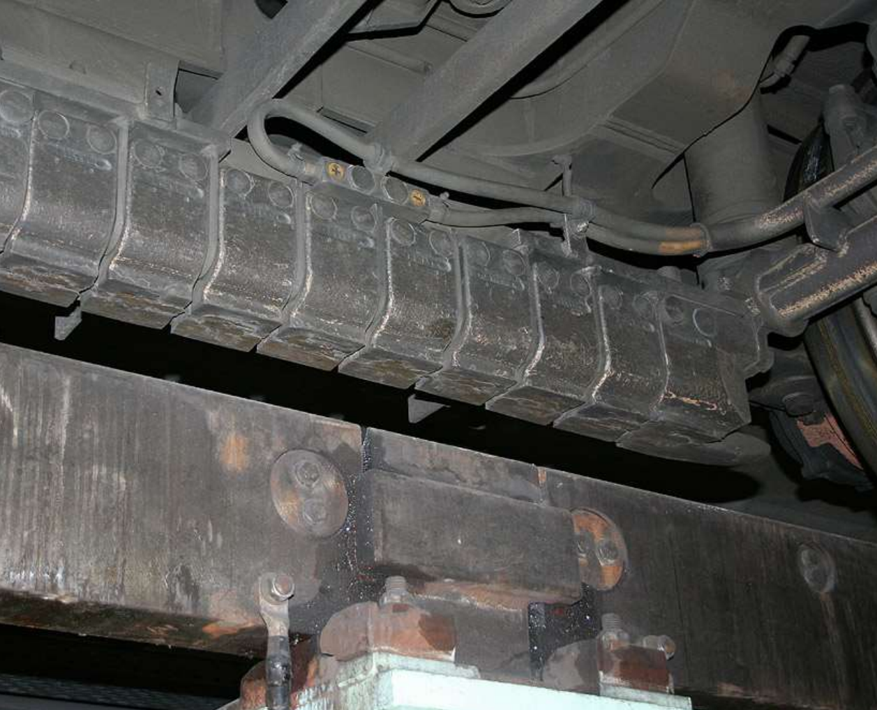
Foto "Magnetschienenbremse im Laufgestell eines ICE 1". Datum: 05.03.2006. Urheber: Sebastian Terfloth. Lizenz: Creative Commons Namensnennung - Weitergabe unter gleichen Bedingungen 2.0 Deutschland (CC BY-SA 2.0 DE) ( https://creativecommons.org/licenses/by-sa/2.0/de/deed.de )
