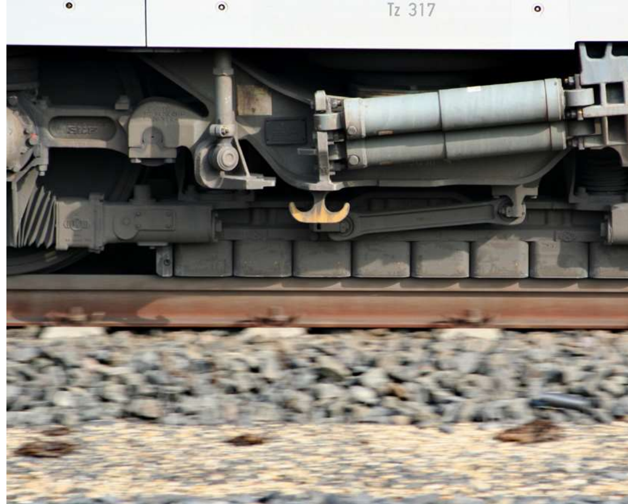
Foto "Aktive Wirbelstrombremse des ICE 3". Datum: 21.02.2008. Urheber: Sebastian Terflot. Lizenz: Creative Commons Attribution-ShareAlike 3.0 Unported (CC BY-SA 3.0) ( https://creativecommons.org/licenses/by-sa/3.0/deed.en )
